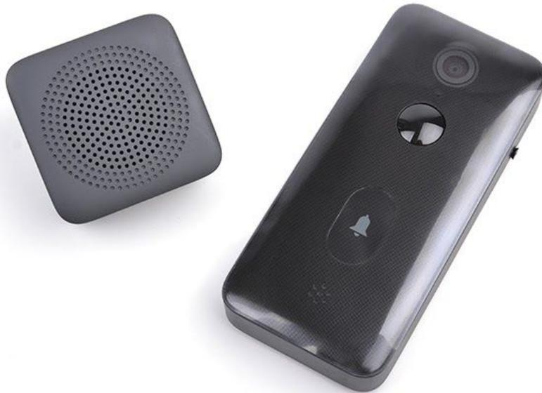
Меньший служит для проигрывания мелодии звонка, его необходимо вставить в розетку внутри квартиры. На боковой грани этого модуля расположена клавиша питания, которая позволяет отключить звук звонка.
